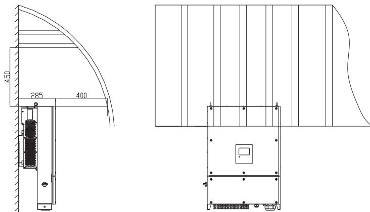
C. 在同一平面安装多台逆变器时，逆变器与逆变器之间安装距离参数如下图所示：
