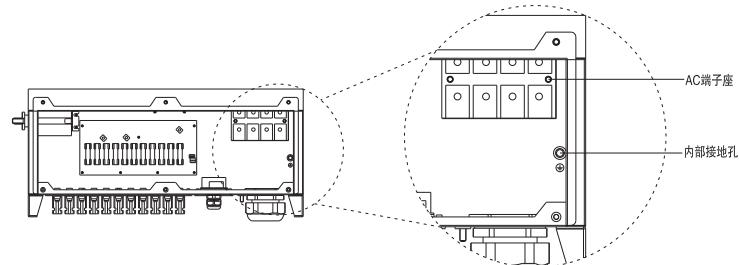
3、先将防水胶壳拧下，然后将电缆线穿过防护壳，根据压线端子规格确定剥线长度，用压线钳压接好线材及端子，并分别连接到相应的通道，拧紧各端的螺丝，图中端子跟实物可能会有差异，如下图所示：
