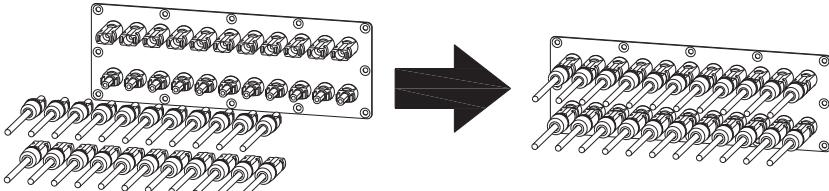
I. 把电池板的正极和负极接线端连接到逆变器对应的接线端，不同型号的逆变器单路最大输入电流值请参考下表：
