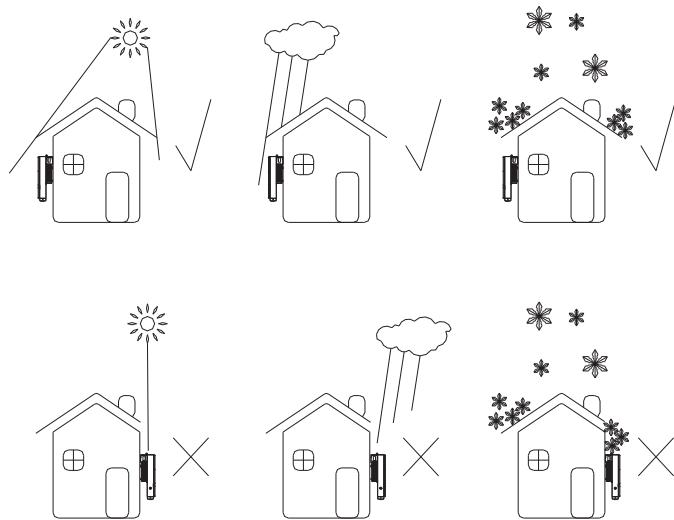
B. 为了减少由于阳光直射造成逆变器降载和延长逆变器寿命，我们建议安装遮阳棚，对于遮阳蓬与逆变器之间距离参数，如下图所示：
