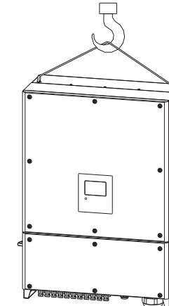
3. 为了保证逆变器能够可靠的固定在墙上，用M6\*10的螺丝把逆变器的侧面固定,如下图所示:
